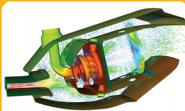
Calcul de combustion dans un moteur d'avion (Snecma Groupe Safran)
